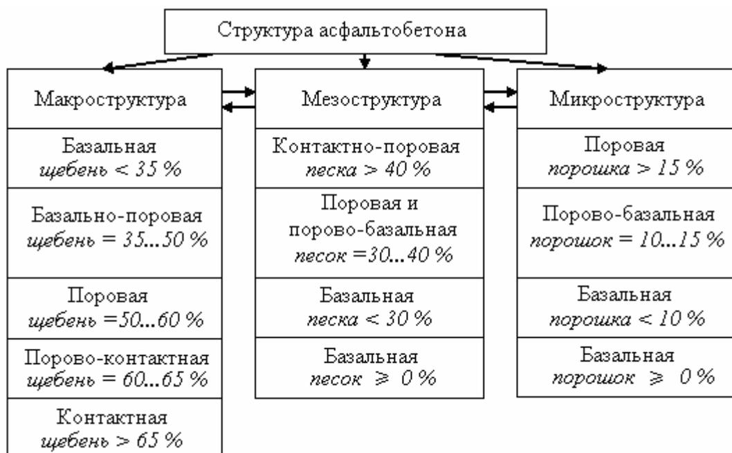
Рис. 2. Взаимосвязь структур в асфальтобетоне
